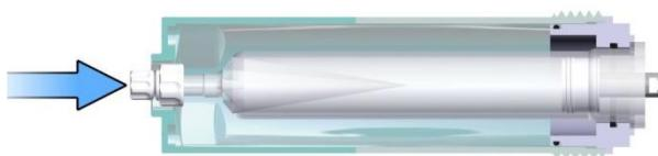
Извлеките дозирующий цилиндр из светозащитного кожуха через верхнюю часть кожуха.
